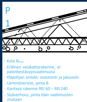
Kuva: Palonkestävä yläpohjarakenne
